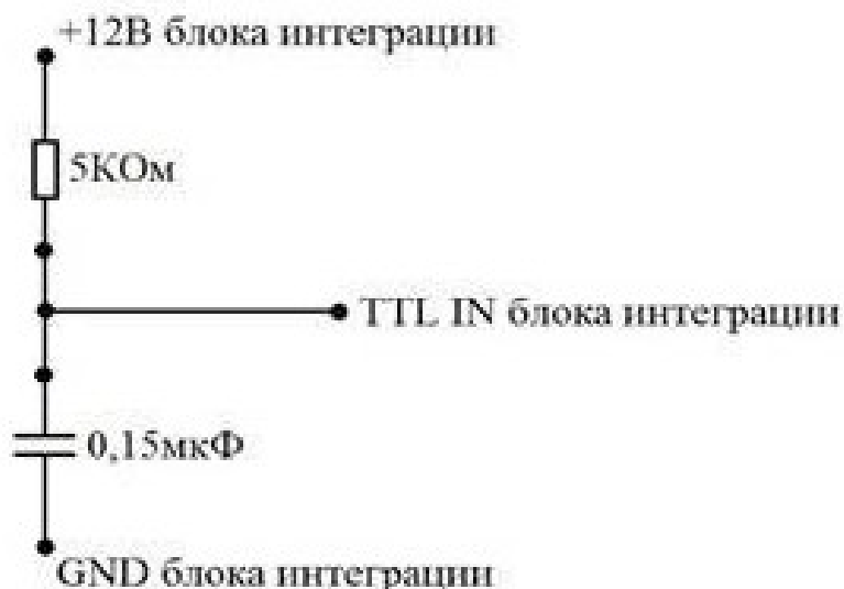
Рис. 22. Схема подключения дополнения к цифровому входу
